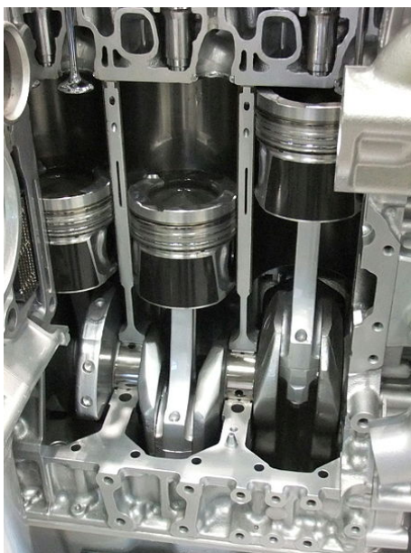
FIGURE 2.21 – Pistons et cylindres d'un moteur automobile découpé.
